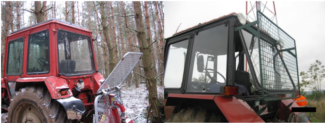
„Mezőgazdasági traktor + csörlő+ védőrács = erdészeti közelítőgép” Megerősített fülke vagy bukókeret hiányzik
